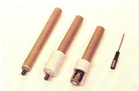
Toplotne sonde TERM so namenjene za hitro in točno merjenje temperature staljene kovine ali drugih talin. Čas meritve je do 6 sec. Sonde TERM so primerne za sisteme, ki so sestavljene iz sonde in merilne palice, kjer je nameščen priključek, kateri poveže merilni nastavek z merilno napravo. Standardno se dobavljajo sonde TERM s termočlenom PtRh10%-Pt (po potrebi so možni termočleni PtRh13%-Pt ali PtRh6%-PtRh30%).
